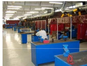
Production : 22 cabines de soudage, 22 postes TIG- ARC EE, 2 rouleuses dont une CN, 2 poinçonneuses dont une CN, un banc de découpe plasma HD, 3 plieuses dont 2 CN, 5 postes MIG MAG, une cisaille CN, un rack de yauterie, 4 tables de montage, une potence de levage, une scie à ruban, une encocheuse, une tronçonneuse, 6 perceuses, 2 cisailles à lames courtes, une presse plieuse horizontale
