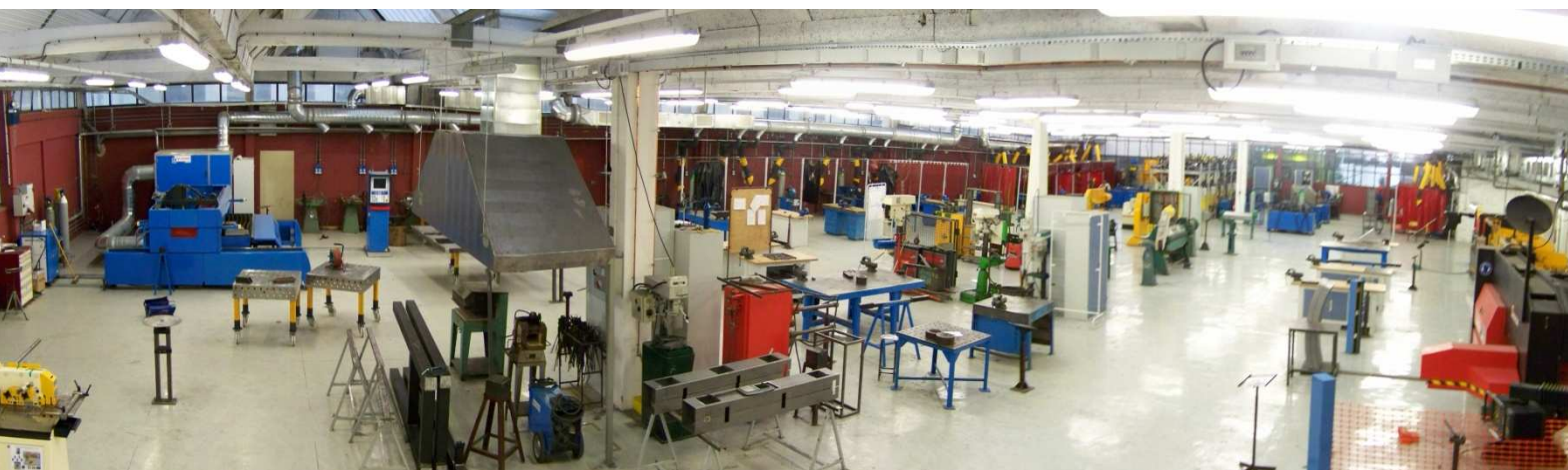
Production : 22 cabines de soudage, 22 postes TIG- ARC EE, 2 rouleuses dont une CN, 2 poinçonneuses dont une CN, un banc de découpe plasma HD, 3 plieuses dont 2 CN, 5 postes MIG MAG, une cisaille CN, un rack de yauterie, 4 tables de montage, une potence de levage, une scie à ruban, une encocheuse, une tronçonneuse, 6 perceuses, 2 cisailles à lames courtes, une presse plieuse horizontale
